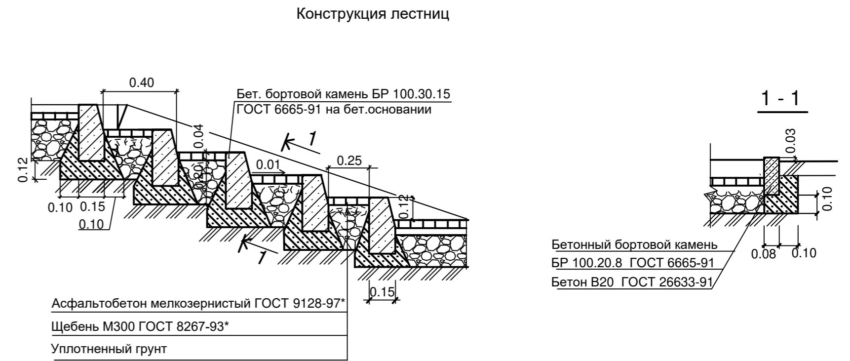
Ведомость объемов работ на лестницы шир.2,0м
